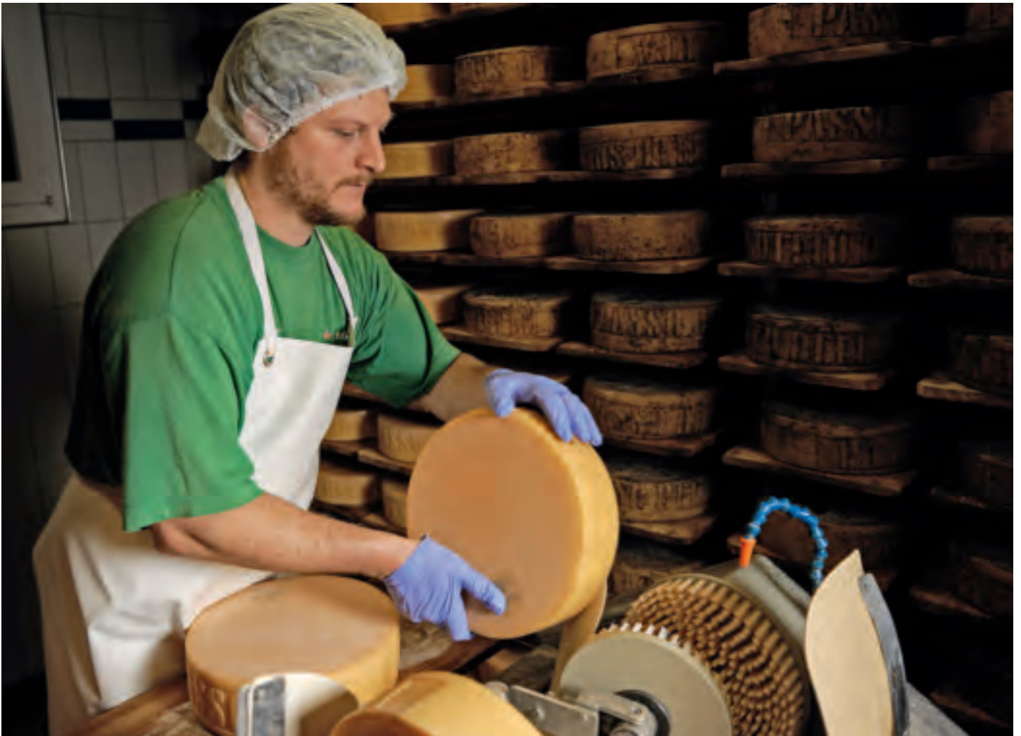
Im kürzlich erweiterten Käsekeller hilft eine Maschine dem Mitarbeiter Michael Aebersold beim Käseschmieren.
